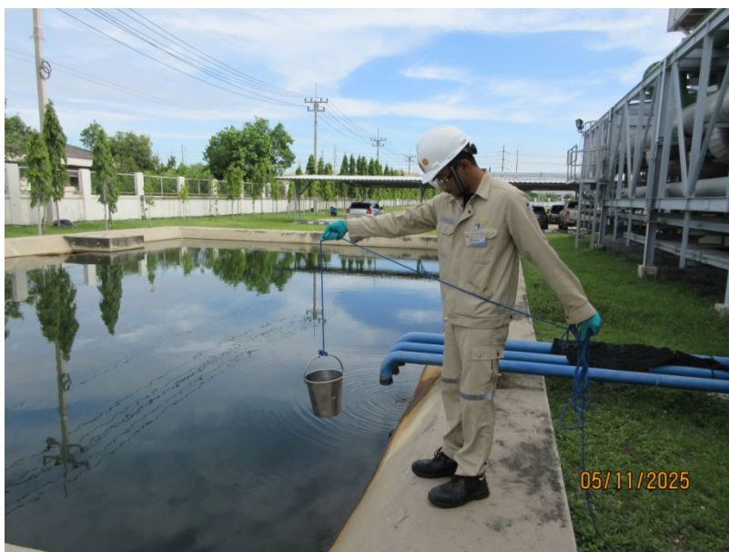
บ่อตรวจสอบคุณภาพน้ำทิ้งก่อนระบายเข้าสู่ระบบบำบัดน้ำเสียส่วนกลางของ นิคมอุตสาหกรรมบางปะอิน
